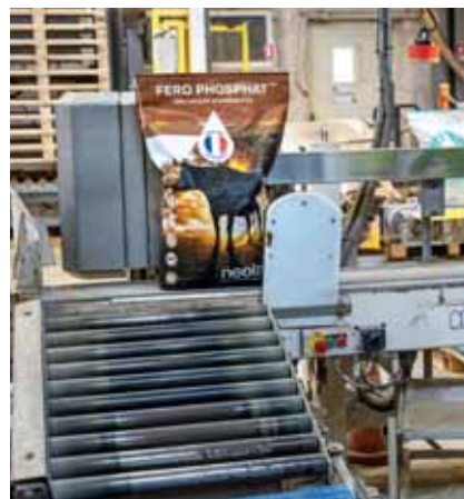
Chaîne de conditionnement d'aliments minéraux.
