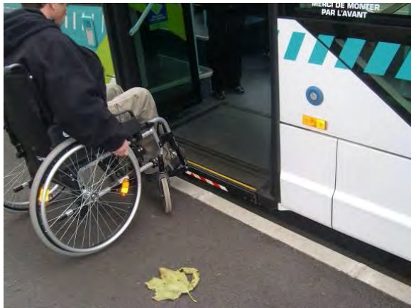
Arrêt Fontenelles (TREGUEUX) quai à 18cm – sans rampe d'accès ni agenouillement : accessible avec faible lacune
