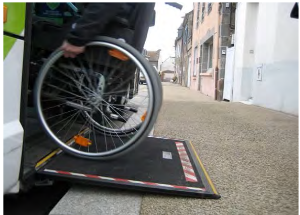
Arrêt Pordic Centre – quais 19cm – rampe d'accès sans agenouillement : accessible
